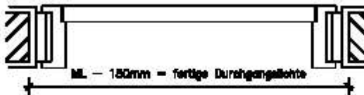
Umfassungszarge für stumpfwinkelchlegendes Türblatt mauerbündig mit Alu Einbauboek Voraussetzung für diese Zargeart ist ein sehr genau verputztes Mauerwerk
