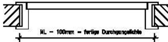
Umfassungszarge für stumpfwinkelchlegendes Türblatt Voraussetzung für diese Zargeart ist ein sehr genau verputztes Mauerwerk
